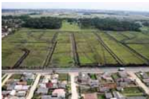
Valas de secagem do loteamento
