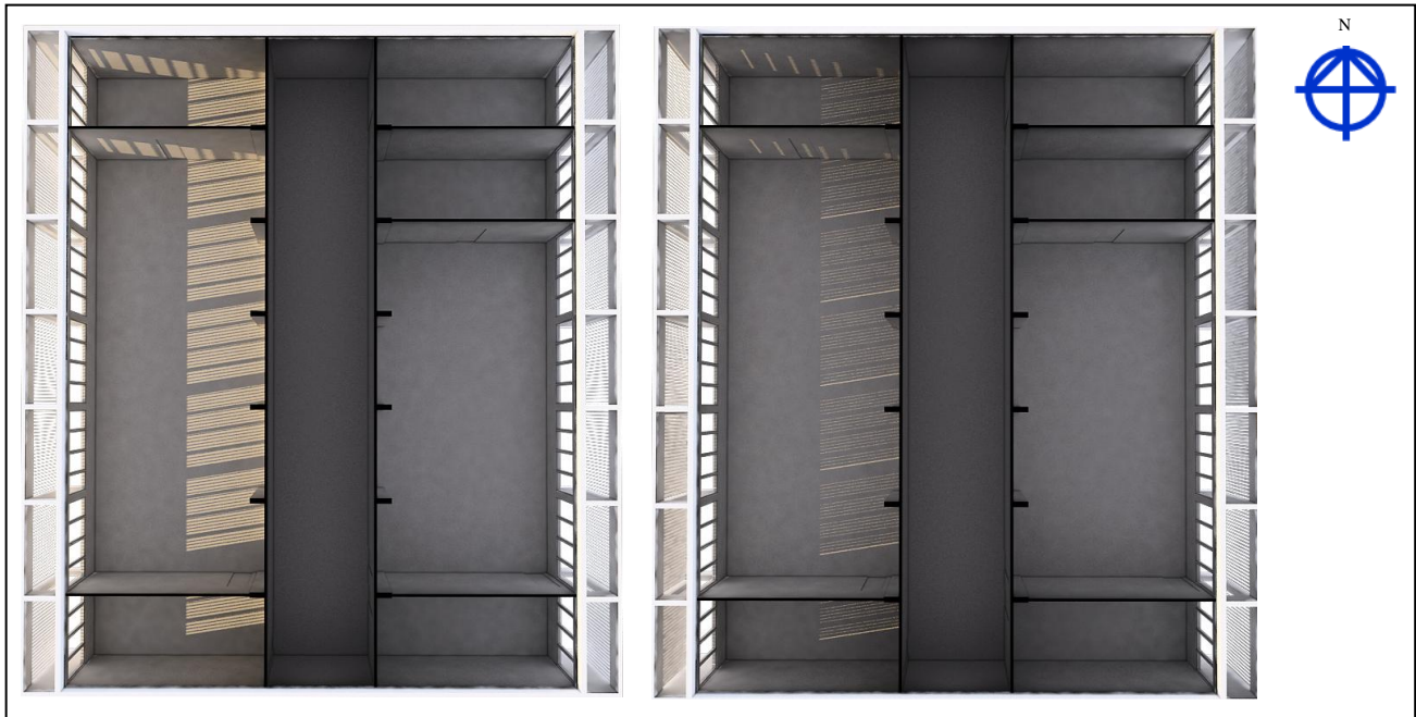
FIGURA. Estudo de insolação Pavilhão do Comando – Dia 23 de Fev/ 20 Out – 17:00 hs - à esquerda com Ambiente Brise aberto e à direita com Ambiente Brise 45°
