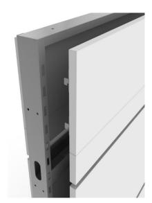
O corpo da estrutura das divisórias é composto por dois painéis, sendo que o painel inferior, na altura do rodapé, é totalmente removível permitindo o acesso ao leito de cabeamento sobre o piso e acesso à instalação de tomadas se for necessário; permite também, o fácil manuseio para a passagem de fiação aos leitos superiores.
